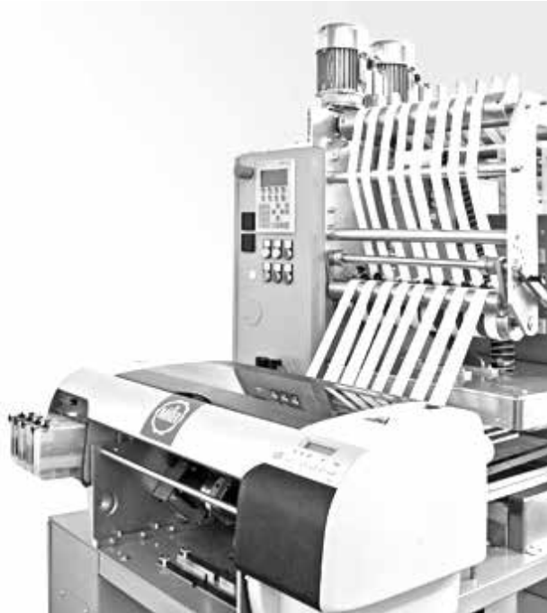
شکل ۳- چاپگر جوهرافشان MUPRINT MDP2 E برای پارچه‌های عریض تولید کمپانی Jakob Muller
