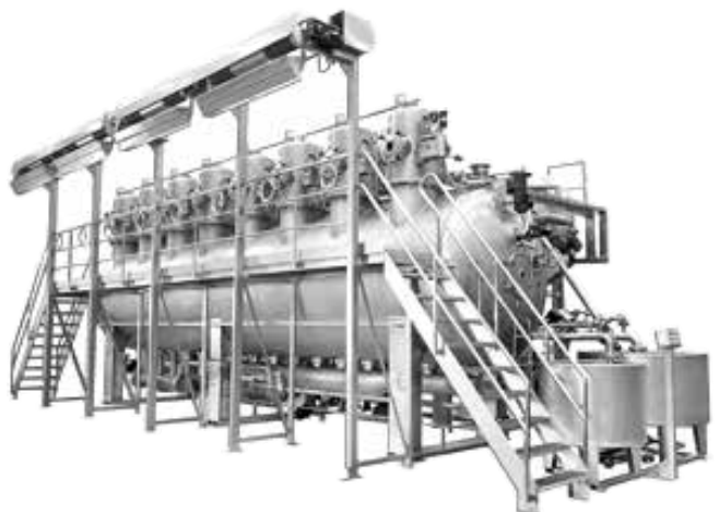
شکل ۲- ماشین رنگریزی پارچه Jumboflow تولید کمپانی Fongs با کاهش مصرف آب، انرژی و زمان انجام فرایند
