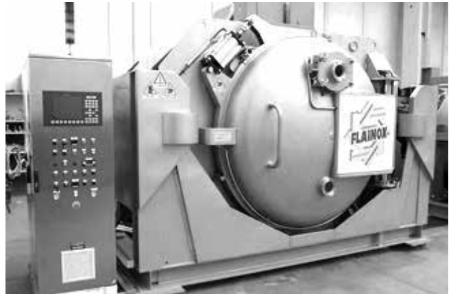
شکل ۱- ماشین رنگریزی NRG-DL تولید کمپانی Flainox S.r.l با L:G ۱:۵
