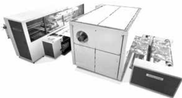
شکل ۴- چاپگر جوهرافشان ReNOIR-Compact برای چاپ کاغذ در چاپ انتقالی تولید کمپانی Reggiani
