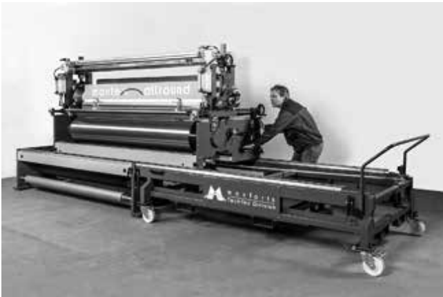
شکل ۶- تکنولوژی پوشش دهی Allround® تولید کمپانی Monforts برای پارچه‌های با عرض کامل
